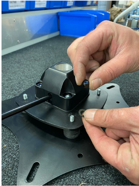
Schritt 6 PRO MATIC mit den Muttern befestigen und mit einem Schraubenschlüssel anziehen.
